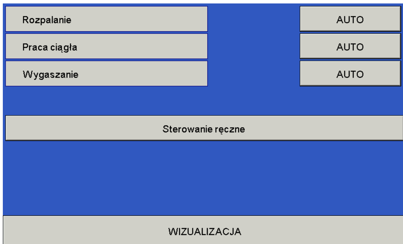
rys. 14.2 Ekran załączeń urządzeń kotłowych.
